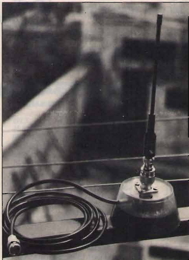
foto 1 La base d'antenna magnetica come si presenta a realizzazione ultimata, forata, e con i suoi accessori montati.
